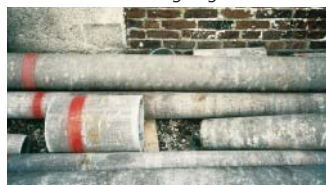
Canalisation en amiante-ciment
