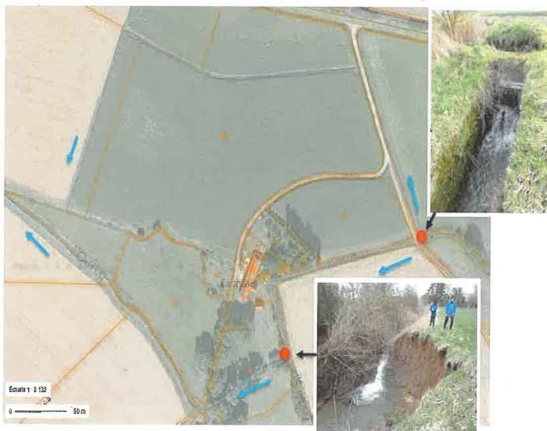
Au droit de la chute en aval du bief, le risque d'érosion régressive est important et s'observe depuis le déchaussement de l'ouvrage.
