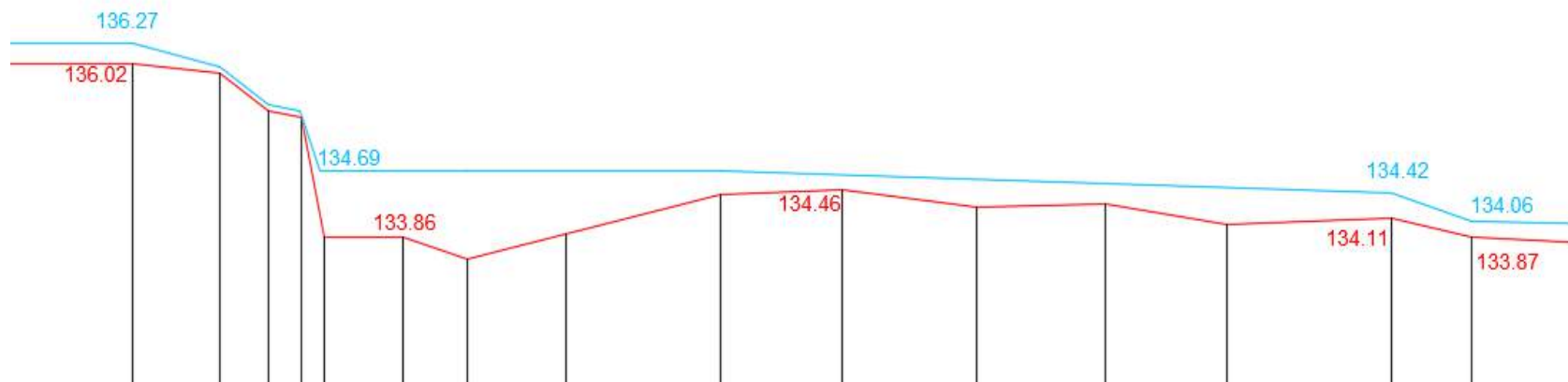
Profil en long de la chute liée à l'ancien ouvrage de décharge du Ru de Coupé
